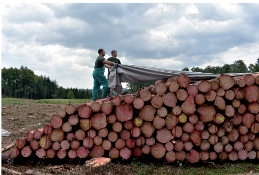
Obrázek 3. Zakrývání skládky netkanou textilií při technologii Mercata
