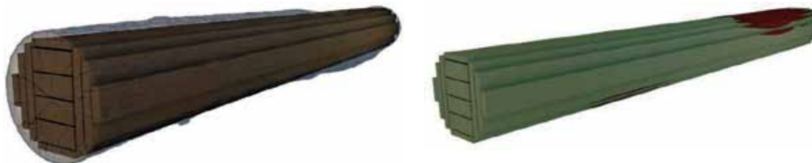
Obrázok 4. Rezný plán v modeli reálnej guľatiny Figure 4. Cutting pattern in real log models.
