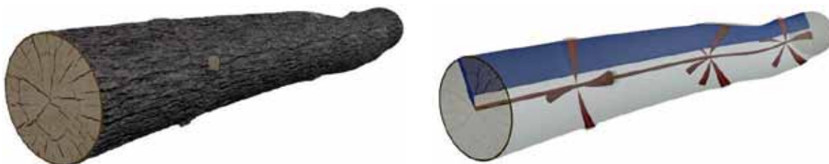
Obrázok 3. 3D model guľatiny s detegovanými chybami Figure 3. 3D model of a log with detected defect.
