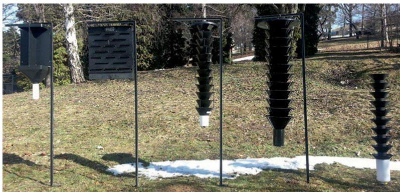
Obrázok 3. Rôzne porovnávané typy lapačov (zľava Ecotrap, Theysohn, Lindgren, lieviový prototyp, lapač BEKA)
