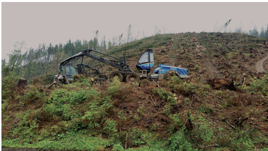
Obr. 7. Pracovná skupina harvester + VKS denne spracuje až 200 – 250 m 3
