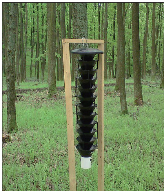
Obrázok 1. Lapač Lindgren funnel trap (12 lievnikov, mokrý variant)
