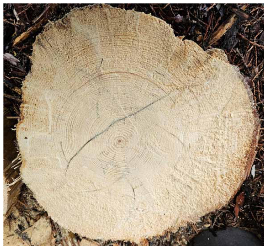
Obrázok 6. Chodby jadrohloda jedľového ( Treptoplatypus oxyurus Dufour) prechádzajú naprieč celým kmeňom
